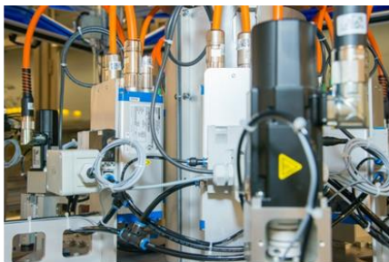
Die dezentralen Servoregler AKD-N sind platzsparend um die Mittelachse der Maschine platziert.
