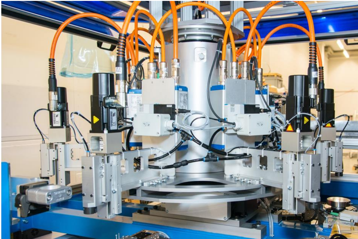
Die Servomotoren der KOLLMORGEN Reihe AKM fahren auf dem Rundschalttisch mit.
