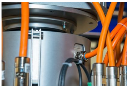
Unscheinbar, aber wirkungsvoll: Kabelverbindung vom Schleifring zur Antriebstechnik.
